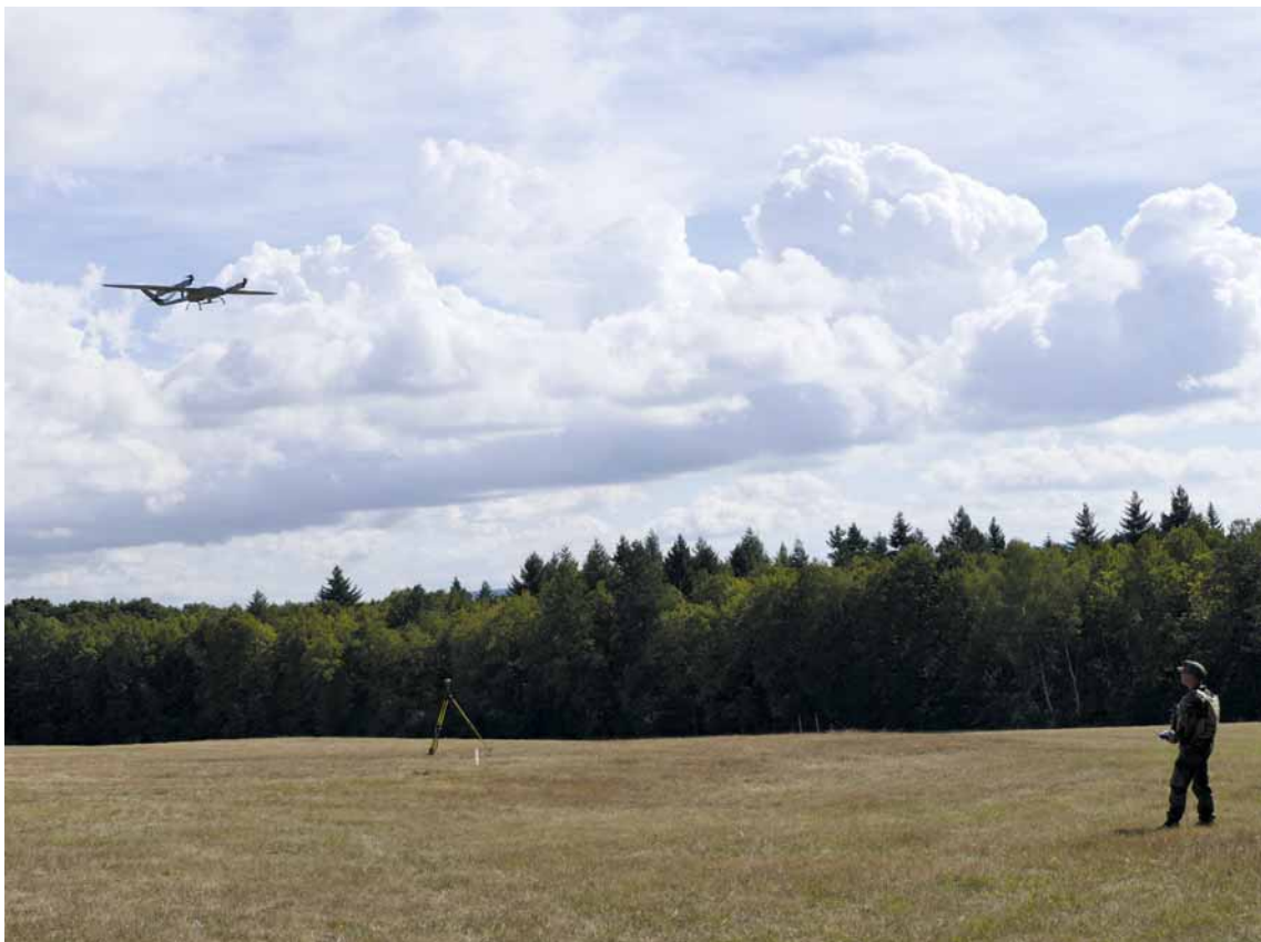
Abbildung 3 | Die Vermessungsdrohne »Germandrone Songbird 150« wird zur Dokumentation und Erfassung von Daten bei Flugunfällen eingesetzt und unterstützt u. a. den General Flugsicherheit bei der Untersuchung von Flugunfällen. (Quelle: ZGeoBw/Keller)
