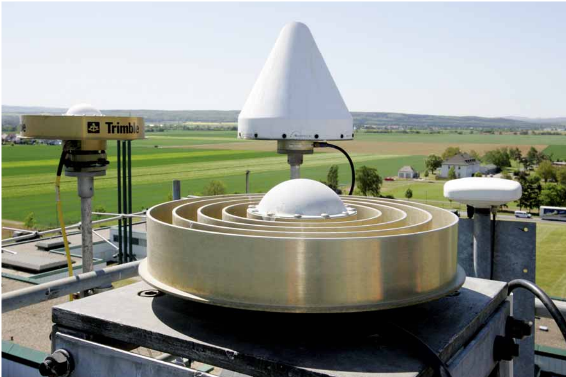
Abbildung 5 | Die Antennenanlage GIBSBw ist auf dem Hauptgebäude des ZGeoBw in Euskirchen verbaut. (Quelle: ZGeoBw)
