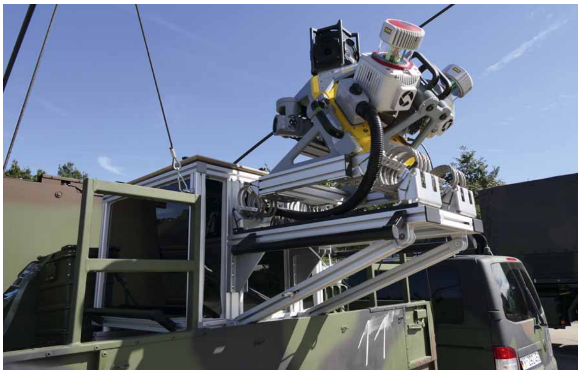
Abbildung 2 | Der Trimble MX9 Sensor zur kinematischen Datenerfassung ist auf dem geschützten Fahrzeug EAGLE IV verbaut. (Quelle: ZGeoBw/Keller)
